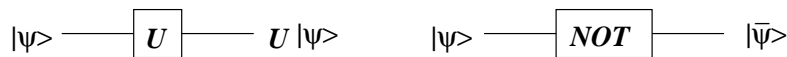
Obrázek 4: 1-qubitová kvantová brána: Na obrázku vlevo je znázorněna obecná operace působící na jeden qubit |\psi\rangle . Jako příklad je vpravo uvedena brána NOT .
